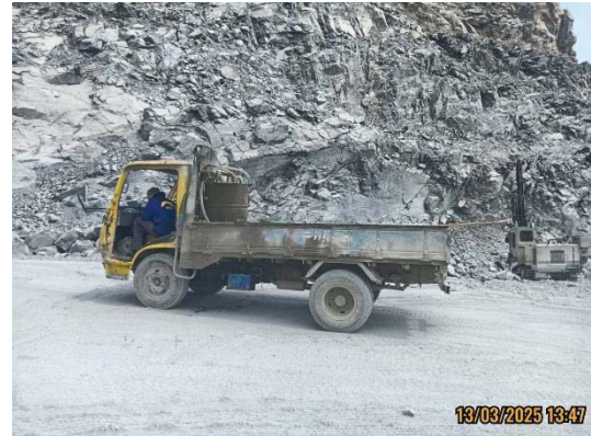
รูปที่ 3-20 รถไถเรณให้สัญญาณเตือนก่อนทำการระเบิดหิน
