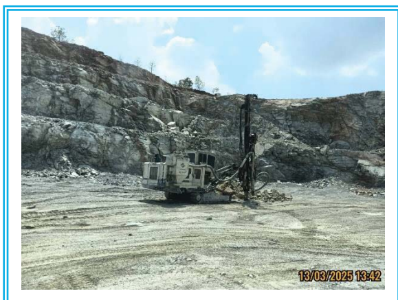
รูปที่ 3-7 เครื่องเจาะระเบิดที่มีอุปกรณ์เก็บฝุ่นติดไว้กับหัวเจาะ
